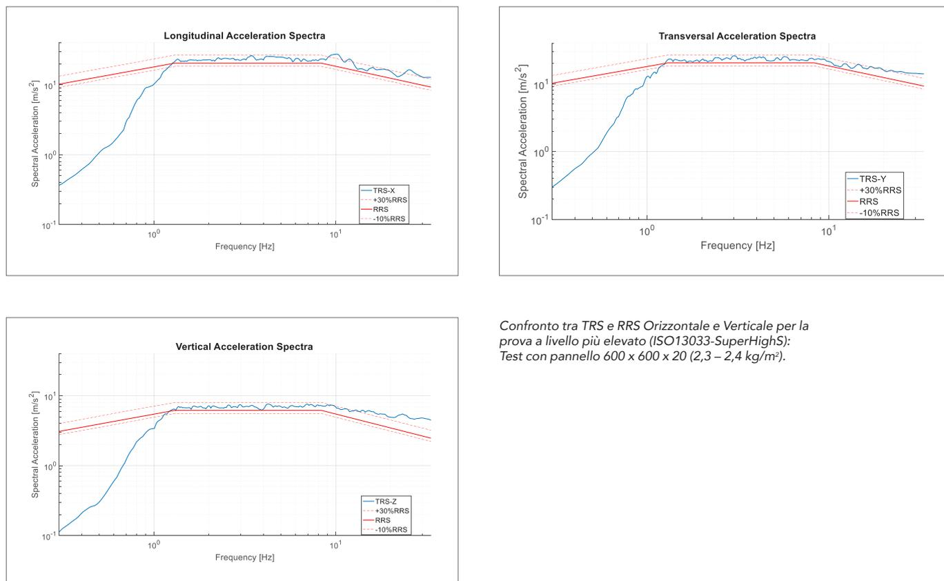
Confronto tra TRS e RRS Orizzontale e Verticale per la prova a livello più elevato (ISO13033-SuperHighS): Test con pannello 600 x 600 x 20 (2,3 – 2,4 kg/m<sup>2</sup>).
