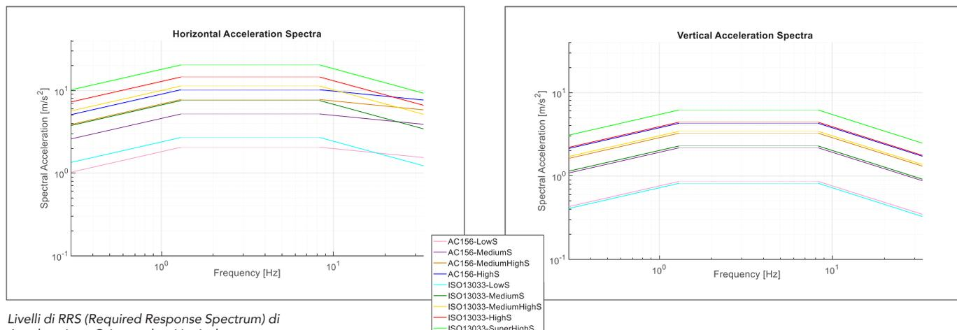
Livelli di RRS (Required Response Spectrum) di Accelerazione Orizzontale e Verticale.
