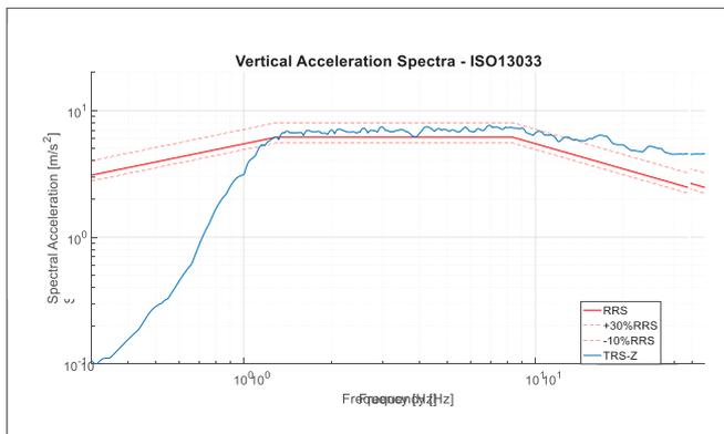
Confronto tra TRS e RRS Orizzontale e Verticale per la prova a livello più elevato (ISO13033-SuperHighS):
