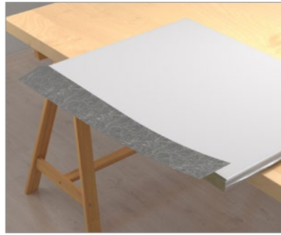
3. Allineare il nastro per 5 mm sulla parte frontale del pannello e premere.
