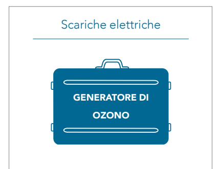
Viene trasformato in ozono con una scarica elettrica.
